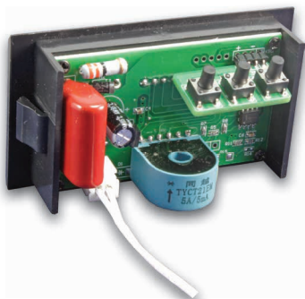
Рис. 3 – Otix PQ74-A1-1 с подключенными панелью программирования и питанием
